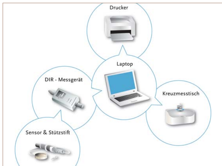
Abb. 7: Arbeitsschema des DIR®Systems
